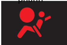
Đèn cảnh báo hệ thống túi khí
