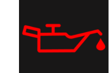
Đèn cảnh báo áp suất dầu động cơ
