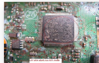
Nước gây rỉ làm hỏng bản mạch
