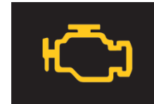
Đèn báo sự cố
