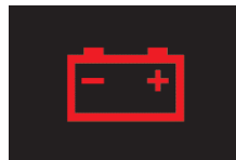
Đèn cảnh báo hệ thống nạp điện
